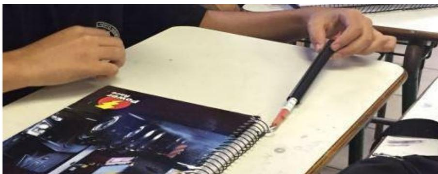
**Figura 6:** Estudante utilizando o dinamômetro para medir a força de atrito estático máxima entre o caderno e a mesa.
